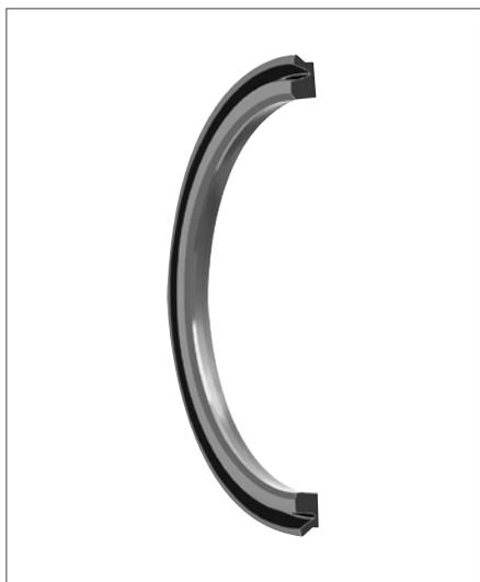
Die Kolbendichtung Profil Z8 ist ein einfach wirkender Lippenring für die Abdichtung von Kolben in Pneumatik-Zylindern und Ventilen. Sie zeichnet sich durch geringe Einbaumaße aus. Die Standard-Baureihe Profil Z8 entspricht den Zylinderdurchmessern nach ISO 3320 bzw. CETOP RP 52 P, RP 43 P und RP 53 P.
